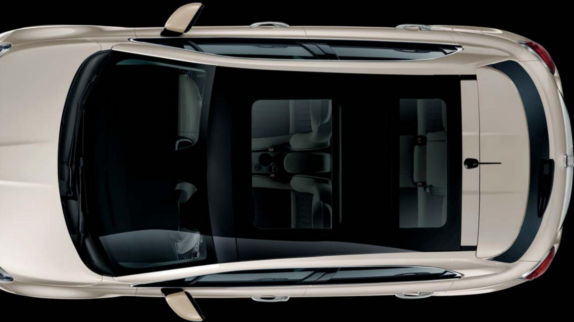
Teto de vidro de grandes dimensões com comando elétrico.
